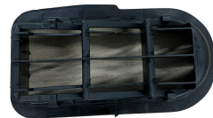
空気抜き (トランク)
